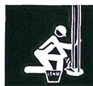
Entfernen von Umkleidungen und Isolierungen aus dem Gefahrenbereich bei Arbeiten an Rohrleitungen, Kesseln und Behältern.
